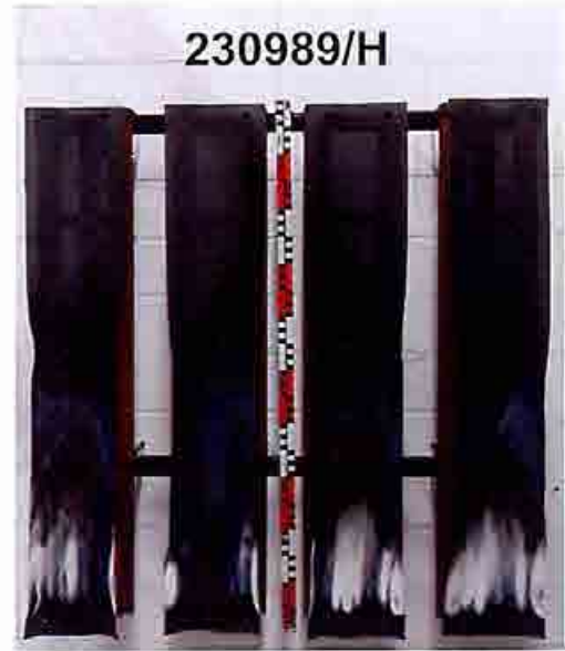
Bild 16: Aussehen der Proben (Probekörper H) nach dem Versuch Figure 16: Appearance of the samples (test specimen H) after the test
