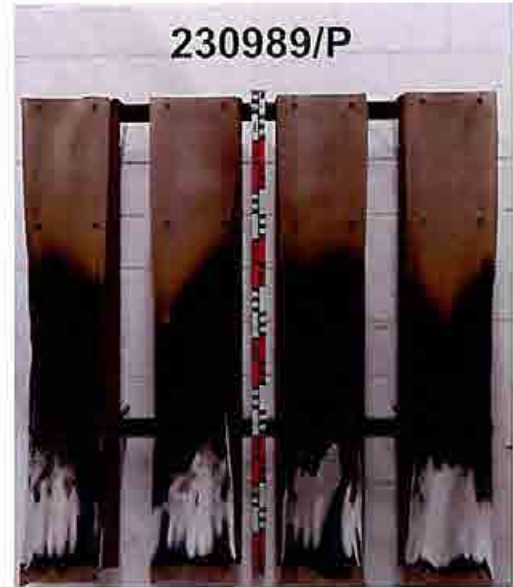
Bild 32: Aussehen der Proben (Probekörper P) nach dem Versuch Figure 32: Appearance of the samples (test specimen P) after the test
