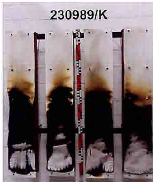
Bild 23: Aussehen der Proben (Probekörper K) nach dem Versuch Figure 23: Appearance of the samples (test specimen K) after the test
