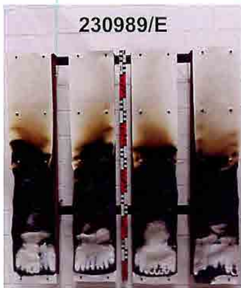
Bild 11: Aussehen der Proben (Probekörper E) nach dem Versuch Figure 11: Appearance of the samples (test specimen E) after the test
