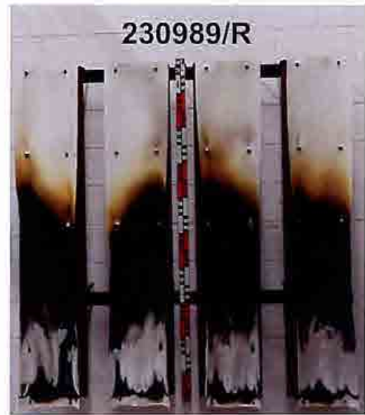
Bild 36: Aussehen der Proben (Probekörper R) nach dem Versuch Figure 36: Appearance of the samples (test specimen R) after the test
