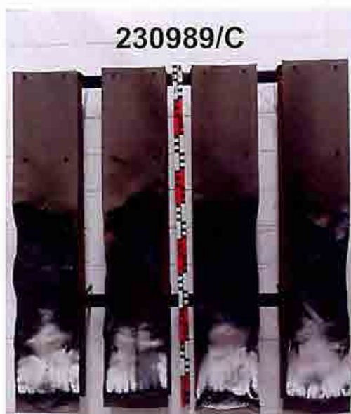
Bild 7: Aussehen der Proben (Probekörper C) nach dem Versuch Figure 7: Appearance of the samples (test specimen C) after the test
