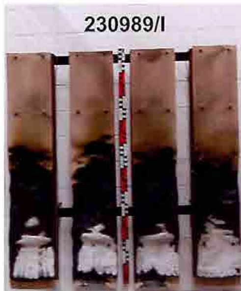
Bild 19: Aussehen der Proben (Probekörper I) nach dem Versuch Figure 19: Appearance of the samples (test specimen I) after the test
